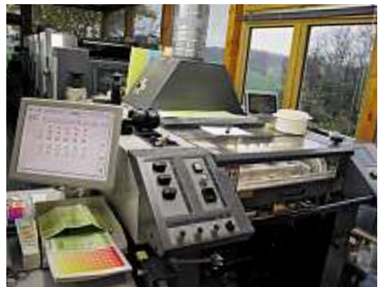
Im Offsetdruck ist Quint seit Dezember 2012 mit der Fünffarben Ryobi 525 GX mit IR-Trockner ausgerüstet.
